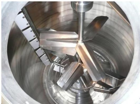
Ci contre une nouvelle technologie **CSC** d'agitation double mouvement jumelé avec un rotor/stator, qui permet de réduire les temps de fabrication.
